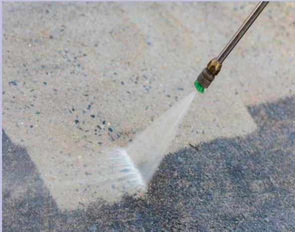
El agua corriente circula por las cañerías de la red pública de abastecimiento a una presión aproximada de 4 bares. Las limpiadoras de agua a presión aumentan esta presión hasta los 150 bares, lo que, junto con la proyección del agua a través de una boquilla de alta presión pequeña, crea un chorro concentrado que golpea fuertemente la suciedad, desprendiéndola de la superficie a limpiar.
